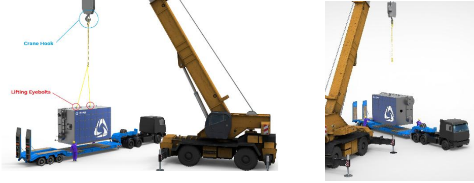
Şekil 3.1.1 – Kazanın Taşıma Aracına Yerleştirilmesi
